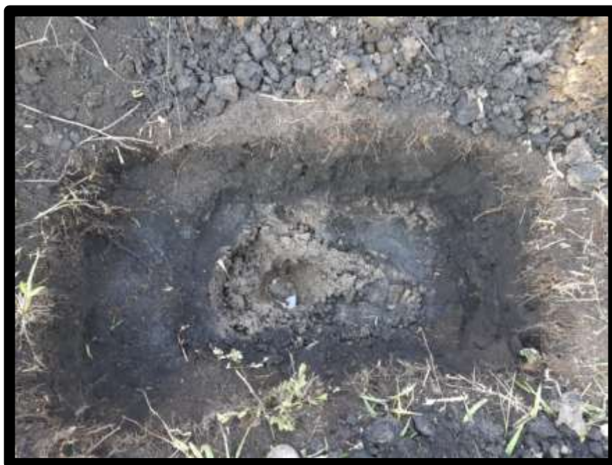
FOTO 3 - Abertura de furo para coleta de amostras
